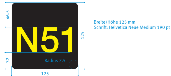
Abb 5.: Grosses Icon – wird bei Tafeln mit einer, drei und vier Linien eingesetzt
